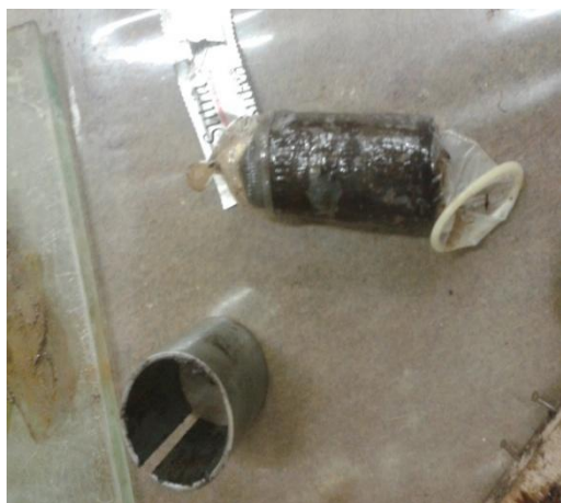
Gambar 3. Sampel tanah setelah dimasukkan ke dalam membran sebagai benda uji pada pengujian triaksial
