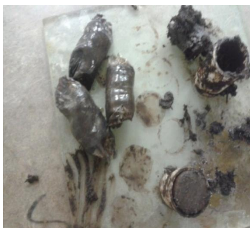
Gambar 4. Sampel tanah gambut setelah dilakukan pengujian triaksial
