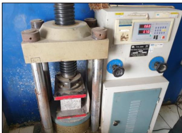
Gambar 3. Uji Kuat Tekan Campuran *Styrofoam* 30%.
