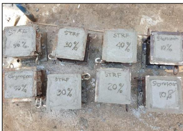
Gambar 2. Benda Uji Beton Kubus
