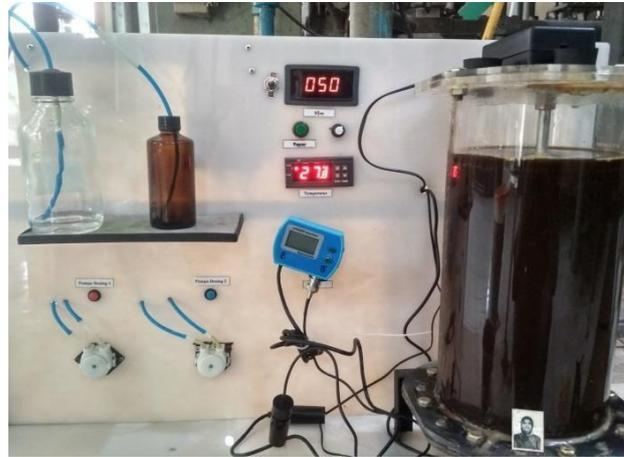
Gambar 2. Proses Fermentasi menggunakan Fermentor
