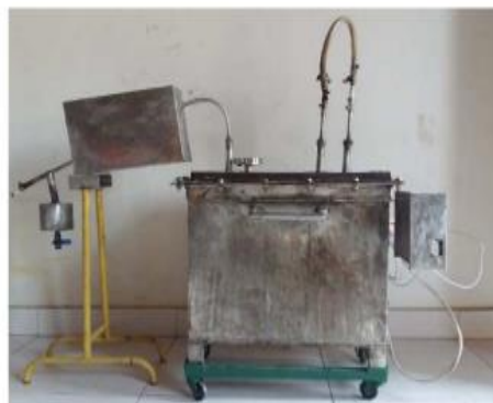
Gambar 2. Sistem Gasifikasi Ampas Tebu (Rizal dkk., 2020)
