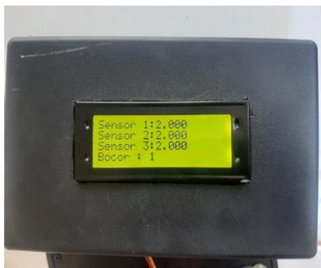
Gambar 6 : Tampilan Flow Bermasalah Pada Sensor Ke-1
