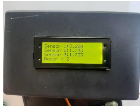
Gambar di atas menjelaskan Gambar 7 Tampilan Nilai Flow Bermasalah Pada Sensor Ke-2 bahwasanya jika yang mengalami masalah
