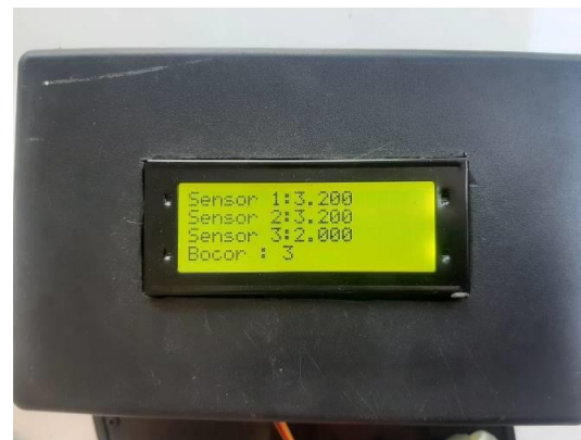
Gambar 8 : Tampilan Nilai Flow Bermasalah Pada Sensor Ke-3
