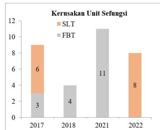
Gambar 2. Data Kerusakan Unit FBT dan SLT
