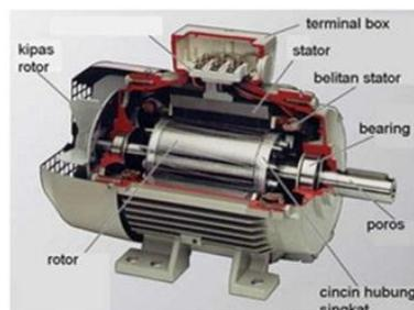
Gambar 3. Konstruksi Motor Induksi 3 Fasa.
