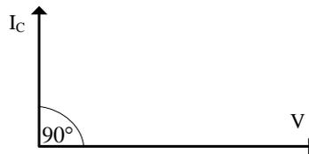
**Gambar 6.** Vektor hubungan V dan I pada beban kapasitif ( $Z = X_C$ )
