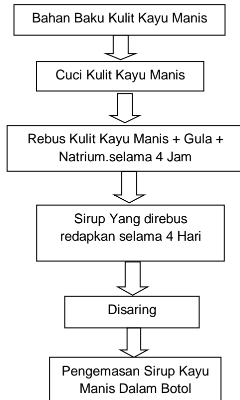
Gambar 2. Diagramatik Proses Pembuatan Sirup Kayu Manis.
